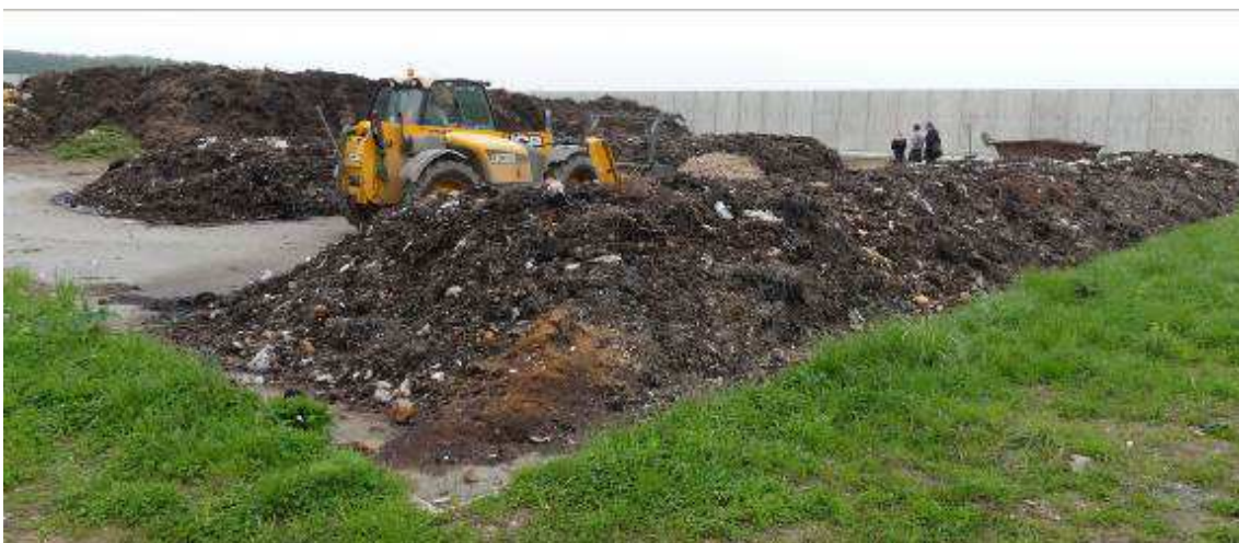
Obr. 4: Vrstvení BRKO kolovým nakladačem (přikrmování) (foto: P. Plíva)
