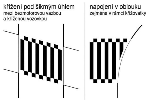
Obr. 2 Detail napojení, křížení šikmé a v oblouku [3]
