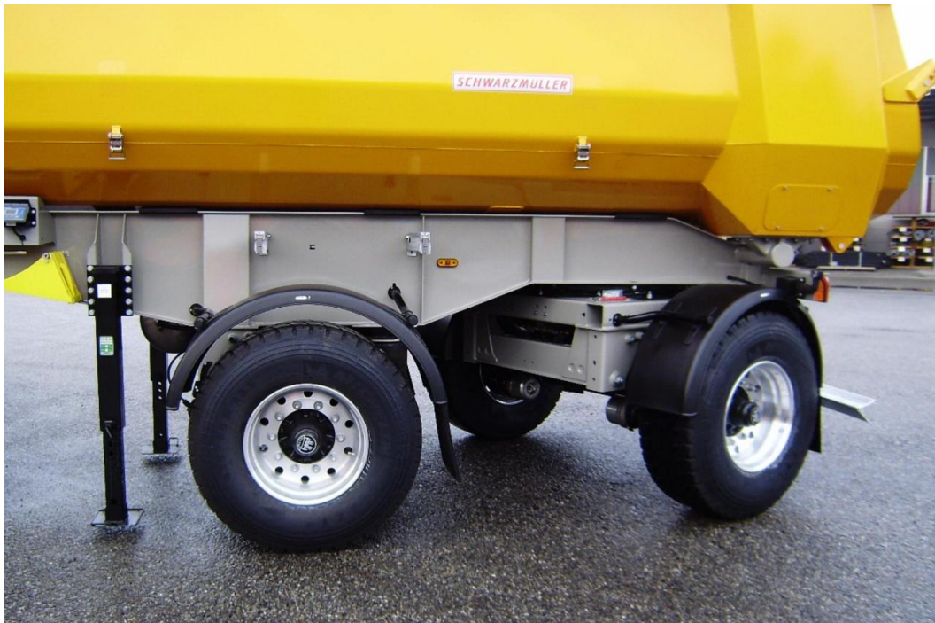
Obr. 42: Řízení tuhou nápravou
