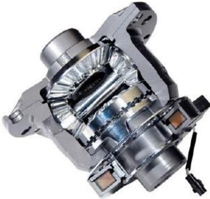
Obr. 17: Elektronicky uzavíratelný diferenciál
